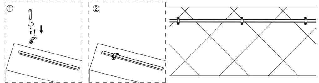
Zur dauerhaften Befestigung verwenden Sie geeignete Schellen oder Halter. Benutzen Sie keinen dünnen Draht oder Ähnliches zum Befestigen, der könnte die Kunststoffbeschichtung beschädigen. Bei längerer bzw. dauerhafter Installation muss der LED-Strip schwingungsfrei befestigt werden, um Leitungsbrüche zu verhindern.
