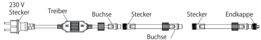
Zur Erweiterung des LED-Strips stecken Sie die Stecker und Buchsen zusammen. Achten Sie bitte darauf das die Überwurfmutter und die Endkappe korrekt und fest verschraubt sind!
