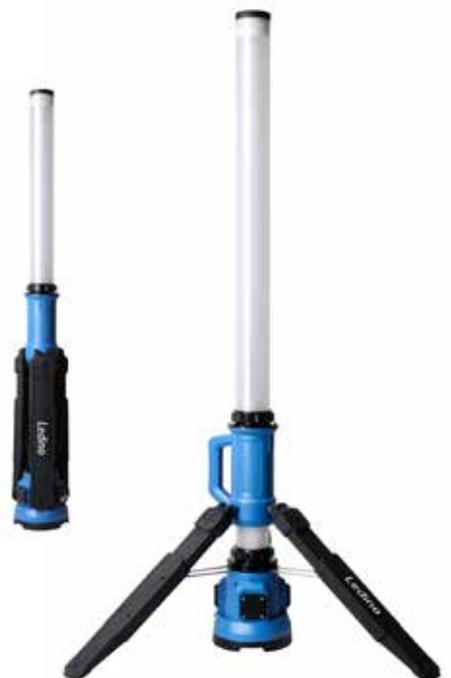
Kunststoffgehäuse mit Kunststoffdiffusor, blau/schwarz, 6500 K, 30.000 Std. Lebensdauer, CRI > 80 Ra, klappbarer Bodenständer, 2 Lichtstufen: 50% (180°)/ 100% (360°), Schutzklasse 1, Energieklasse E, 110 lm/W, Li-Ionen Akku 14,8 V/ 6,6 Ah, 50% Licht = 4 Std. / 100% Licht = 2 Std.
