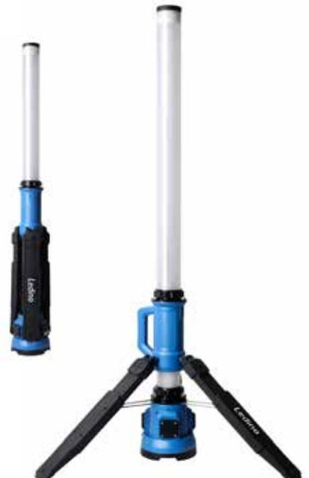
Kunststoffgehäuse mit Kunststoffdiffusor, blau/schwarz, 6500 K, 30.000 Std. Lebensdauer, CRI > 80 Ra, klappbarer Bodenständer, 2 Lichtstufen: 50% (180°)/ 100% (360°), Schutzklasse 1, Energieklasse E, 110 lm/W, Li-Ionen Akku 14,8 V/ 6,6 Ah, 50% Licht = 4 Std. / 100% Licht = 2 Std.
