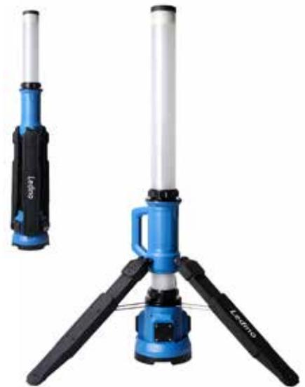
Kunststoffgehäuse mit Kunststoffdiffusor, blau/schwarz, 6500 K, 30.000 Std. Lebensdauer, CRI > 80 Ra, klappbarer Bodenständer, 2 Lichtstufen: 50% (180°)/ 100% (360°), Schutzklasse 1, Energieklasse E, 110 lm/W, Li-Ionen Akku 14,8 V/ 4,4 Ah, 50% Licht = 4 Std. / 100% Licht = 2 Std.
