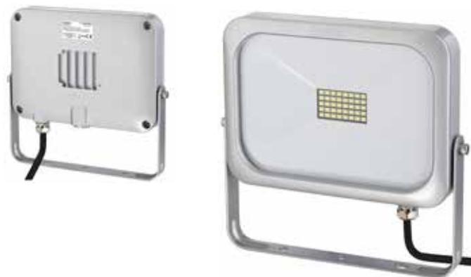
Aludruckgussgehäuse mit Glasdiffusor, 30.000 Std. Lebensdauer, 15.000 Schaltzyklen, 110° Abstrahlwinkel, CRI > 80 Ra, 0,5 m Zuleitung, Energieklasse A+
