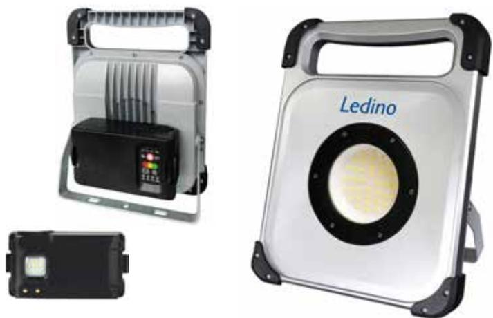
Aludruckguss-/Kunststoffgehäuse mit Sicherheitsglas, silber, 6400 K, 30.000 Std. Lebensdauer, 130° Abstrahlwinkel, Ladekontroll LED, Ladenetzteil, 4-Stufen Licht: 25%/ 50%/ 100%/ Blinklicht, Akkupack mit 3 W LED (300 lm)
