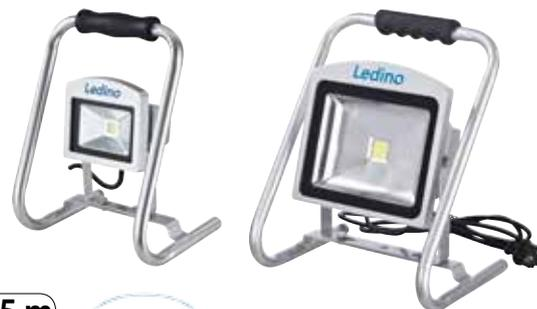
Aludruckgussgehäuse mit Glasdiffusor, silber, 40.000 Std. Lebensdauer, 25.000 Schaltzyklen, 110/110° Abstrahlwinkel, CRI > 80 Ra, Energieklasse A+
